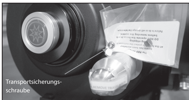
Abbildung H. Entfernen Sie die Transportsicherungsschraube, bevor Sie den Fokussierer in Betrieb nehmen. Vor dem Versand des Teleskops die Schraube wieder eindrehen.
