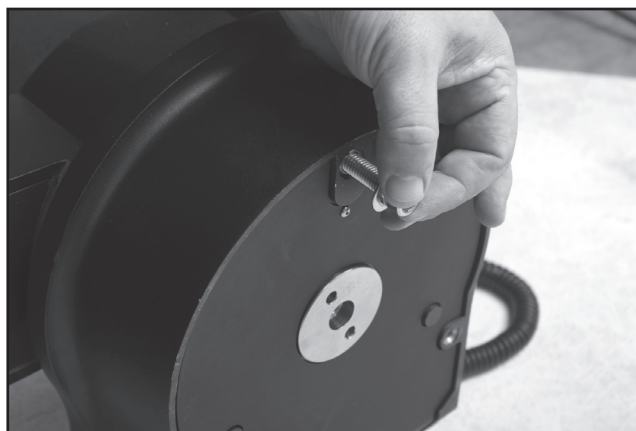
Abbildung I. Befestigen Sie eine der 3/8" Sechskantschrauben am gebogenen Teil des Teleskop-Antriebssockels.
